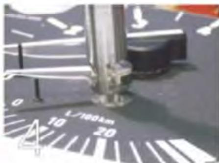
**4.** Die Econometeranzeige mit dem mitgelieferten Abzieher herausnehmen. Hierfür wird der Deckel des Zeigers abgezogen. Die Mittelachse des Zeigers wird jetzt mit dem Dorn gekontert.
