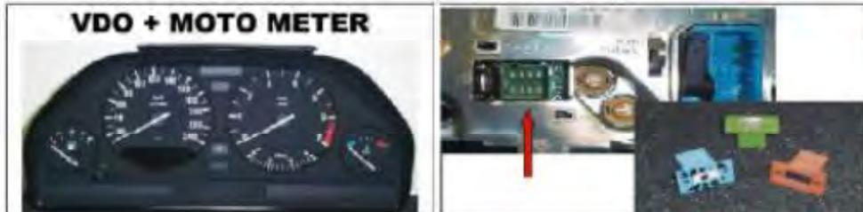
Печатная плата для **коричневого** и **синего** кодирующего штекера Печатная плата для **зеленого** кодирующего штекера
